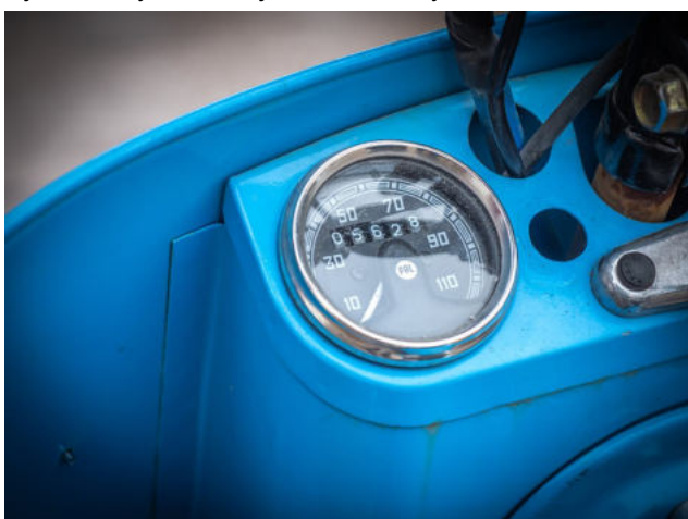
Rychloměr je originál Čezeta. V tuto chvíli však neukazuje spolehlivé údaje, protože kabel Kymco nefunguje přímo se starým měřičem PAL.
