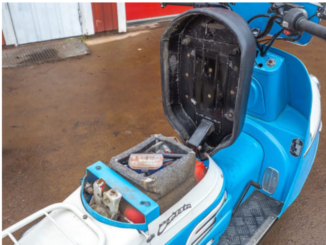
Palivová nádrž postavená z náhradního kanystru byla přesunuta pod sedadlo skútru. Součástí mohou být i potřebné nástroje.
